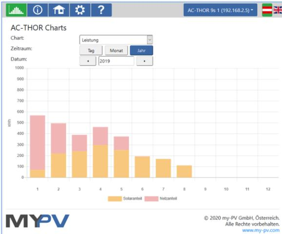
Orange Balken zeigen den Energieanteil der aus der Photovoltaik stammt, rote Balken den Anteil der optionalen Temperatursicherstellung.
