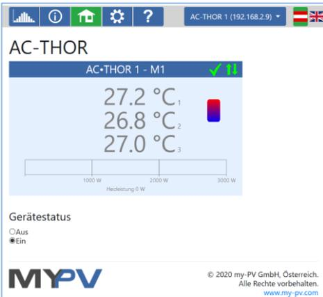
Mit Gerätestatus „Aus“ kann die Steuerung der Last abgeschaltet werden.
