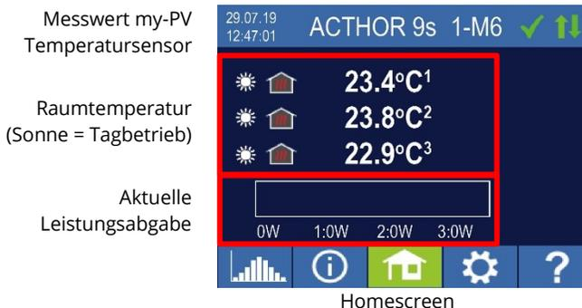
Am Display zeigt ein Symbol von Sonne oder Mond welcher Zeitabschnitt der Raumtemperaturregelung gerade besteht. Für Tag und Nacht können unterschiedliche Mindesttemperaturen vorgegeben werden.
