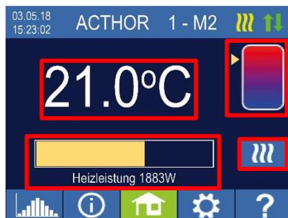
Pfeil zeigt welcher Heizstab gerade versorgt wird. (oben oder unten)
