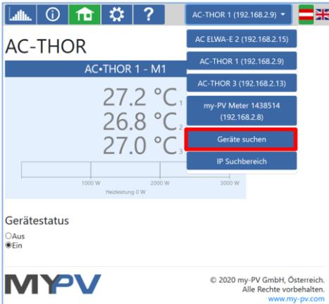
Über eine Schnellauswahl rechts oben kann direkt auf das Web-Interface von anderen my-PV Geräten im Netzwerk zugegriffen werden. Mit dem Button „Geräte suchen“ wird im Netzwerk nach my-PV Geräten gescannt.
